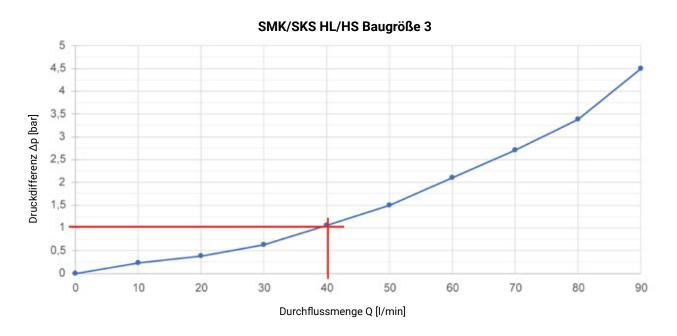
HANSA-FLEX empfiehlt Kupplungen so auszulegen, dass ein max. Druckverlust (max. Druckdifferenz) von 1 bar nicht überschritten wird.
